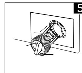
Regréselo a su lugar y ajuste la parte convexa para alinearla con el orificio de la bomba.
