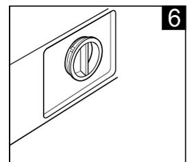
Ajuste la tapa de la bomba en el sentido de las agujas del reloj.
